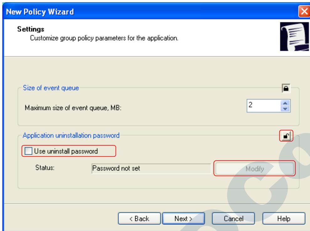
در این پنجره می توانید یکسری پارامترها را تنظیم کنید از جمله اینکه جهت Uninstall کردن Network Agent می توانید Password ست کنید.
