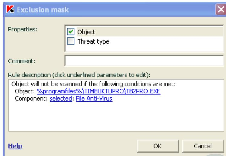
در قسمت Component روی File Antivirus کلیک نمایید تا در پنجره ای که باز می شود تعیین کنید چه Component هایی از آنتی ویروس روی آن فعال نباشد.
