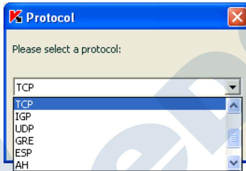
جهت باز کردن پورت RDP، Direction آن را در حالت Inbound & outbound قرار می دهیم و نوع پروتکل را TCP انتخاب می کنیم و وضعیت پورت را در حالت Allow قرار می دهیم.
